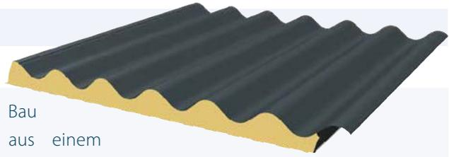
JI Onduroof PIR ist ein isoliertes Dachpaneel für den Bau von Schrägdächern. Das Sandwichpaneel besteht aus einem äußeren Stahlblech mit Wellenprofil, einem Kern aus Polyisocyanurat-Schaum (PIR) ohne schädliche FCKW-HCKW-Verbindungen und einer leicht linierten Innenplatte. Das Außenblech weist die ästhetischen Vorteile eines herkömmlichen Wellblechs auf und ist daher eine ideale Lösung für Renovierungs- und Neubauprojekte im industriellen und landwirtschaftlichen Bereich.
